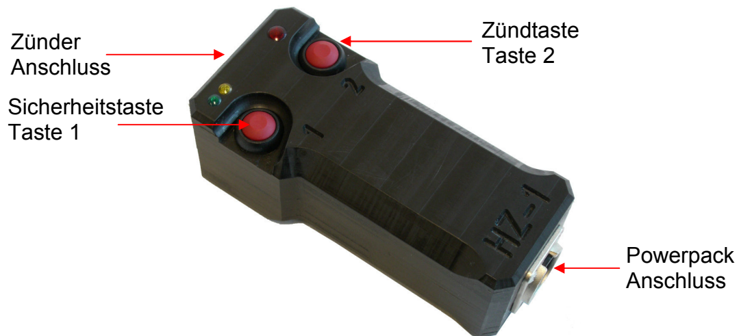
Abbildung 2 - Ansicht oben: Zündgerät
